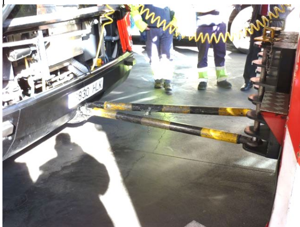
Imagen 5: Lanza doble de remolque y enganche
